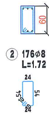
Plan cofrare-armare grinzi Ax L-30x30; 30x60; Sc. 1:00
